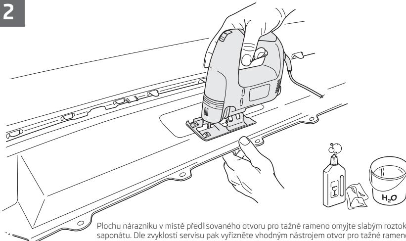
Plochu nárazníku v místě předlisovaného otvoru pro tažné rameno omyjte slabým roztokem saponátu. Dle zvyklosti servisu pak vyříznete vhodným nástrojem otvor pro tažné rameno.
