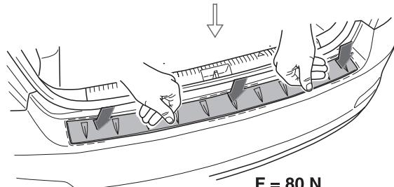
Die Leiste auf einer Seite des Stoßfängers in korrekter Position an gekennzeichneter Stelle ansetzen -siehe Detail-. Danach schrittweise über deren gesamte Länge hin festkleben. Während des kompletten Aufklebevorganges die korrekte Positionierung der Leiste kontrollieren.
