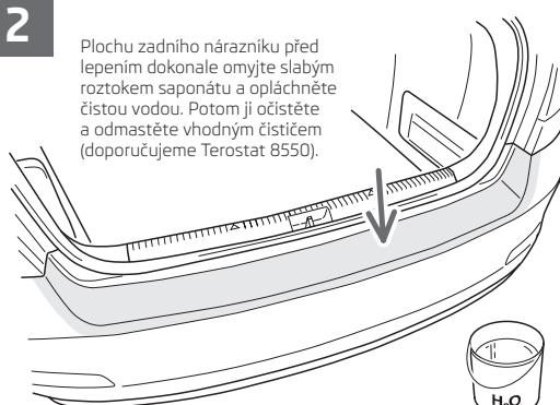
Die Fläche des hinteren Stoßfängers vor dem Aufkleben perfekt mit einer schwachen Seifenlösung abwaschen und mit klarem Wasser abspülen. Sodann mit einem geeigneten Reiniger reinigen und entfetten (wir empfehlen Terostat 8550).
