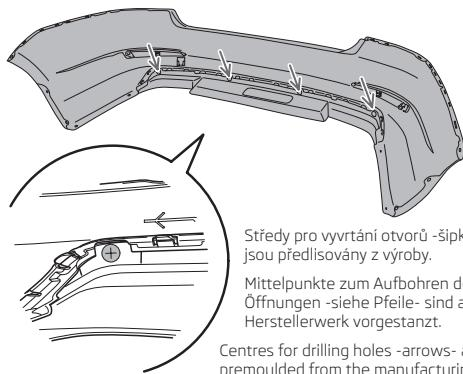
Středy pro vyvrtání otvorů -šípky- jsou předlisovány z výroby.
